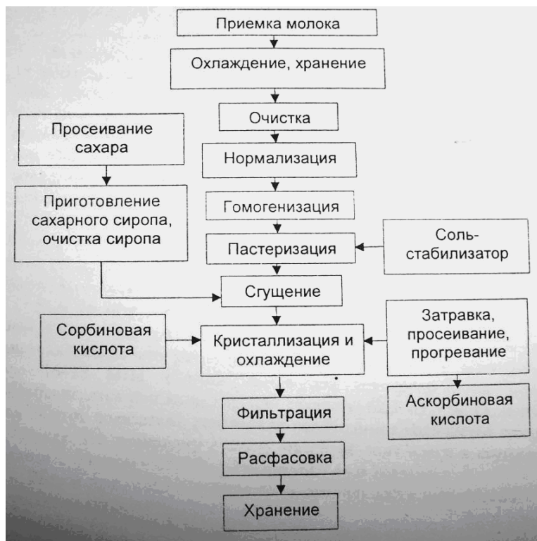
Рис.32. Схема производства сгущенного молока по ГОСТ
