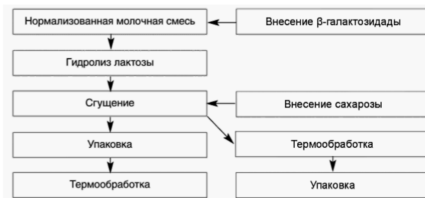
Рис.33. Технология выработки вареного сгущенного молока с сахаром с применением процесса сгущения
