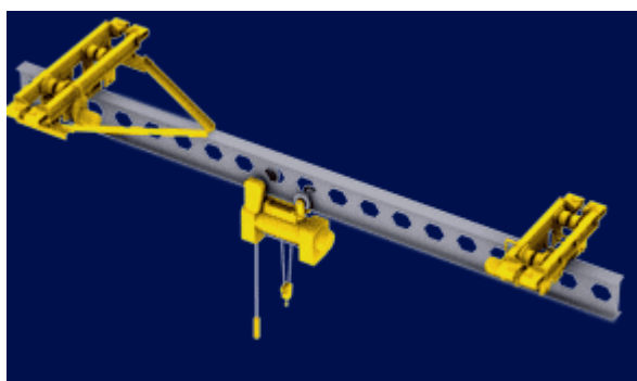
Рис. 19 Кран-балка для складов.
