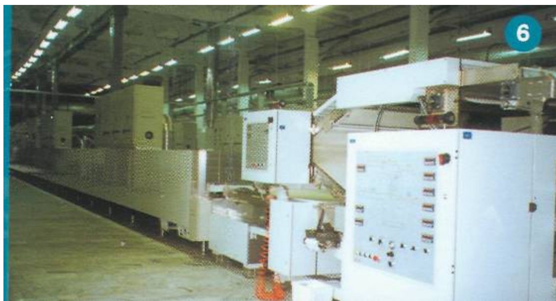
Рис.24. Вход в печь после роторштамповочной машины
