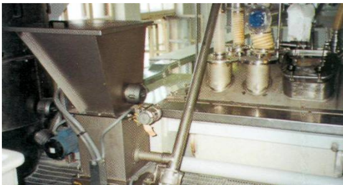
Рис.18 Тестомесильная машина (вид сверху, дозирование сырья)
