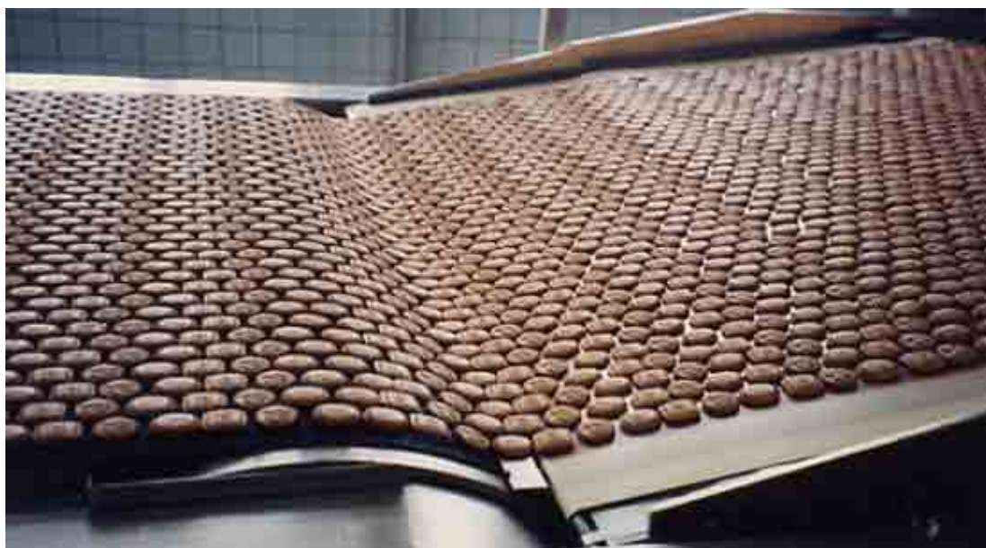
Рис.26. Охлаждающий транспортер. На транспортере диетическое печенье для диабетиков.
