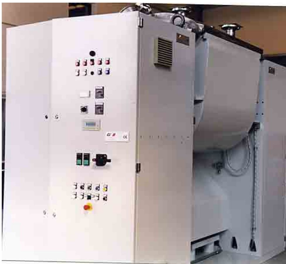
Рис.19 Горизонтальная тестомесильная машина на 800 кг (вид сбоку)
