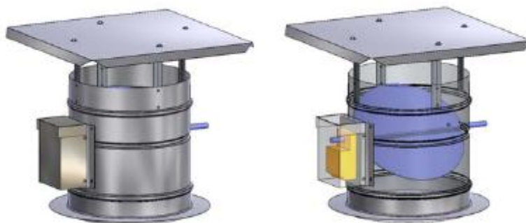
Рисунок 34. Задвижки системы влагоудаления
