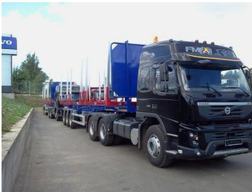
Рисунок 18. Лесовоз Volvo FMX 6x4
