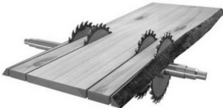
Рисунок 50. Схема работы обрезного станка
