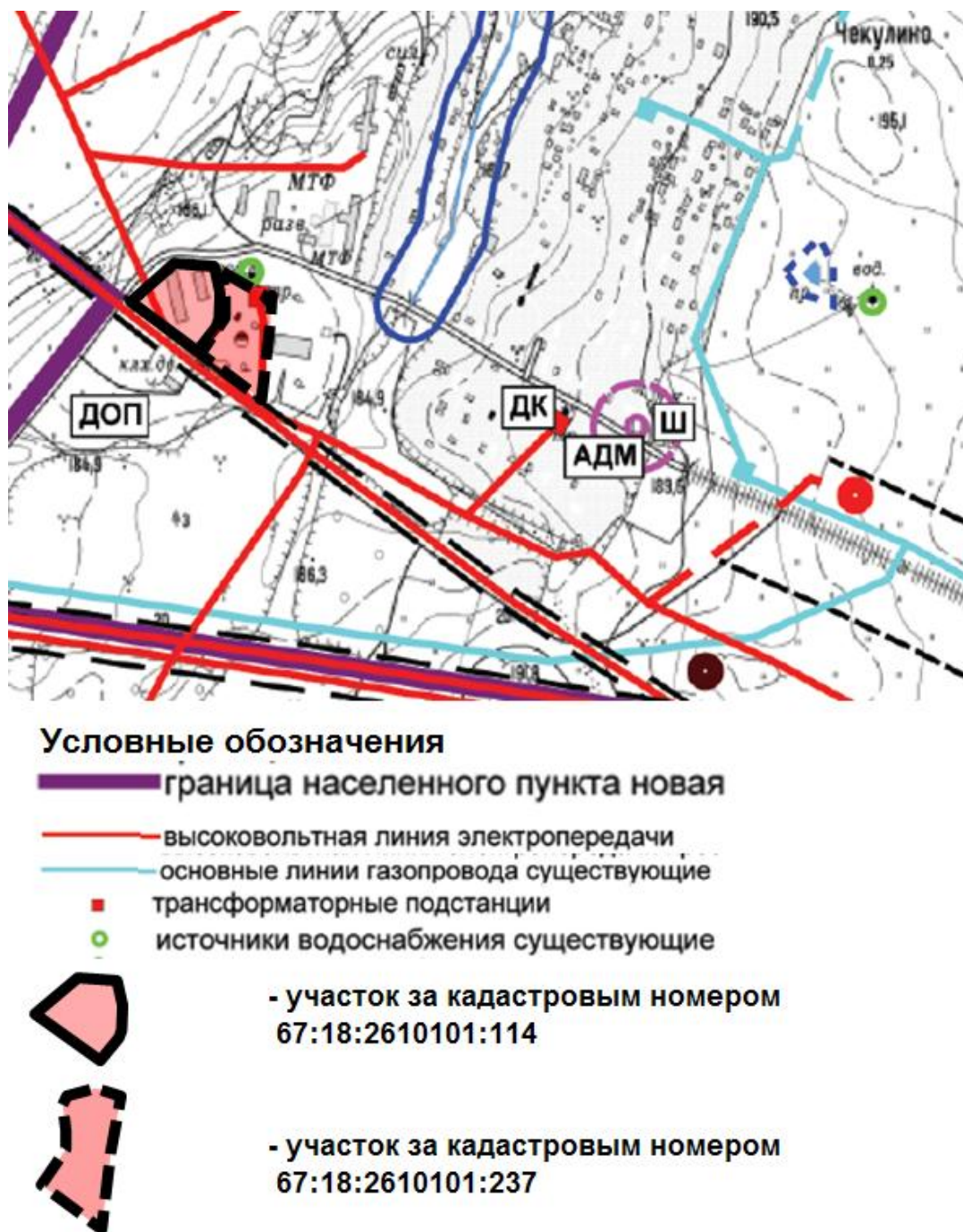
Рисунок 2. Схема расположения участка по отношению к существующим инженерным сетям
