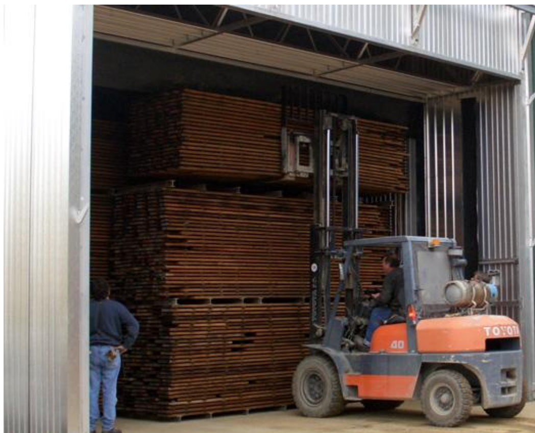
Рисунок 55. Укладка автопогрузчиком штабелей в камеру СМ3000
