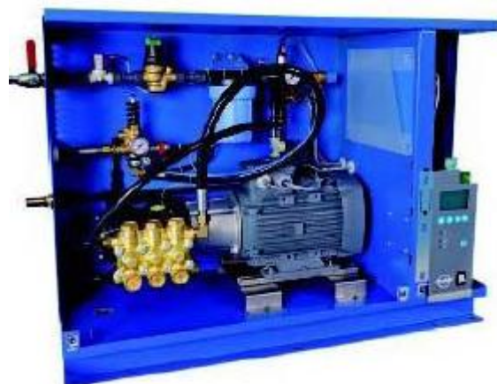
Рисунок 38. Система орошения высокого давления
