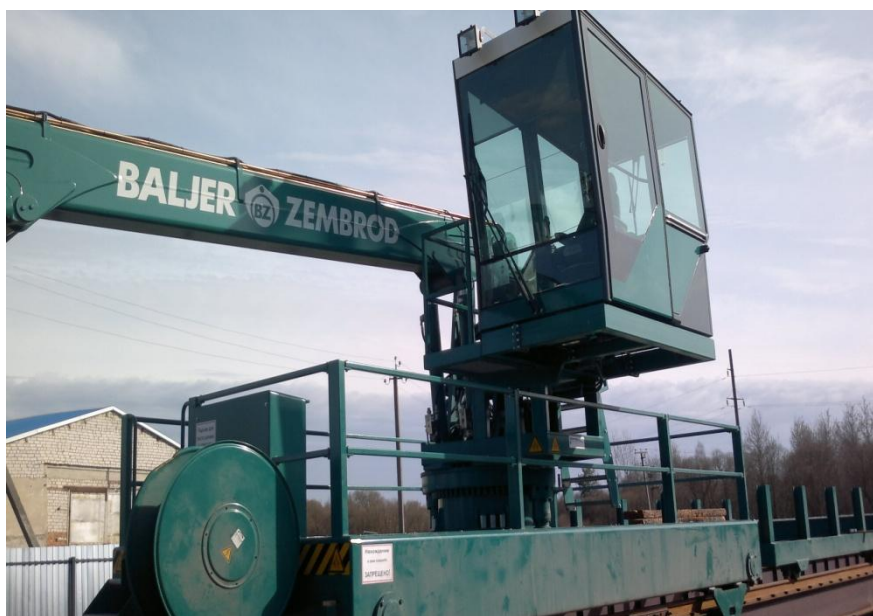
Рисунок 19. Башенный кран-погрузчик на рельсовом ходу
