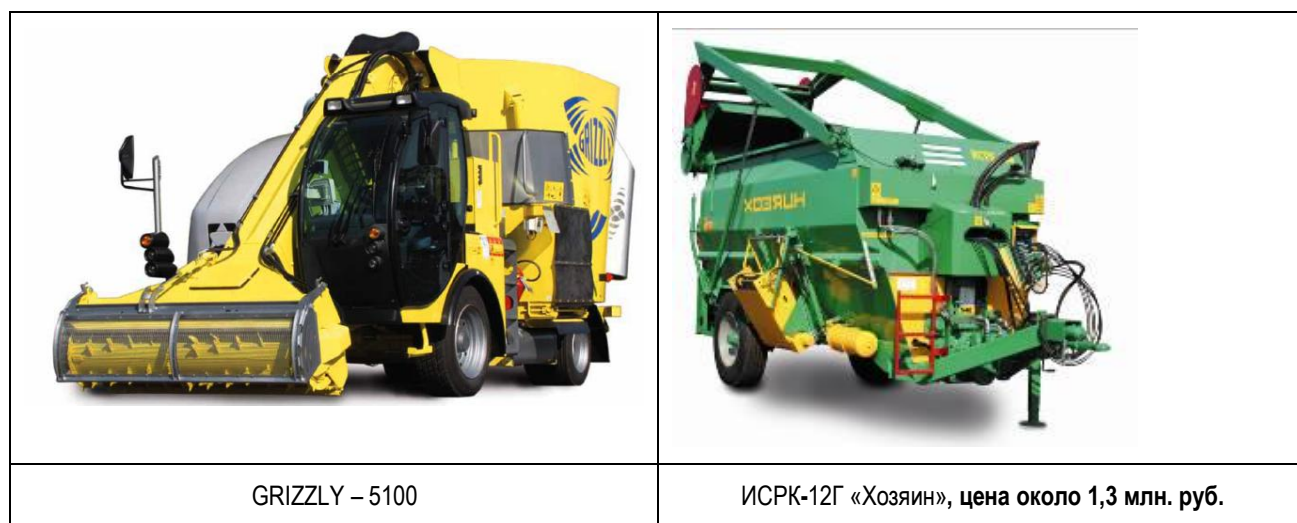
Рис.31. Пример кормораздатчиков-смесителей с самозагрузкой
