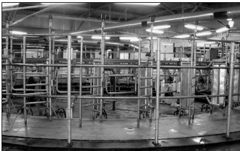
Рис. 18. Доильный зал молочной фермы ЗАО «им. Тельмана» с установкой «Ротолактор-36» («Westfalia Surge»)
