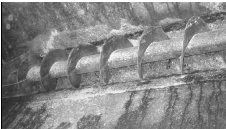
Рис. 44. Шнековый навозоуборочный конвейер КНШ-300 в желобе-накопителе
